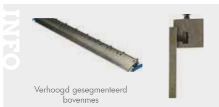
Verhoogde bovenbalk Doorgang 95 mm
