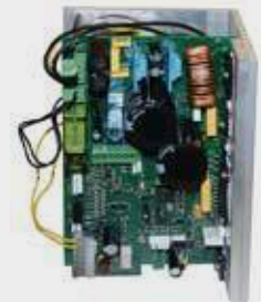
Borstelloze aandrijving TU2506V
