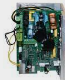
Borstelloze aandrijving TU2506V
