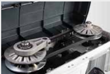
Mechanische variabele snelheidsregeling
