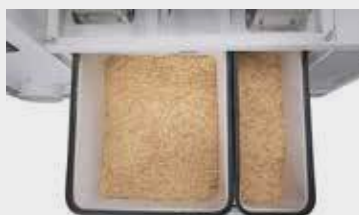
Dubbele opvang voor houtspanen en - stof
