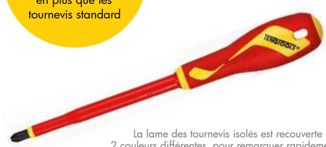
La lame des tournevis isolés est recouverte de 2 couleurs différentes, pour remarquer rapidement si l'isolation est endommagée.
